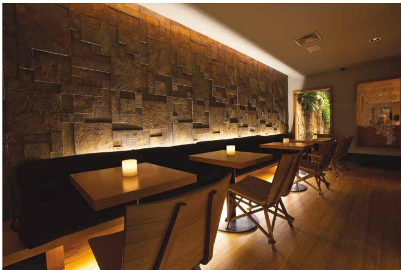
madeiras. A saída encontrada contempla o uso de fita LED de 9,4W/m 3.000K em algumas travas e com alturas diferentes. “Para dar ritmo à luz e levar movimento à fachada”, revela Ana. O terraço, com piso de deque e teto retrátil, conta ainda com arandelas com lâmpadas halógenas palito 100W ligadas ao dimmer.
