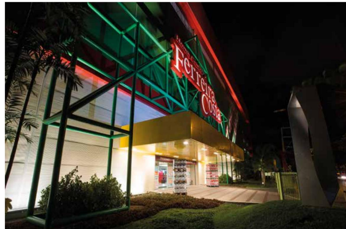
cilíndricas com lâmpadas de vapor metálico PAR 38 (150W, 3.000K, 30°) proporcionam uma luz brilhante e atrativa, atingindo uma iluminância média de 500 lux. "Devido à grande contribuição da luz natural, criamos um sistema com controle para permitir o acionamento parcial durante o dia, e total a partir do final da tarde", diz Cláudia.
