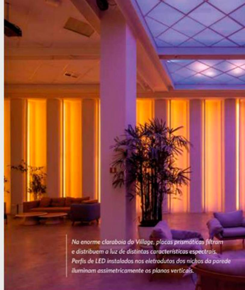
Na enorme claraboia do Village, placas prismáticas filtram e distribuem a luz de distintas características espectrais. Perfis de LED instalados nos eletrodutos dos nichos da parede iluminam assimetricamente os planos verticais.
